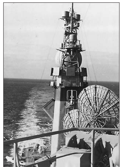
Антенны измерительного комплекса на бизань-мачте
