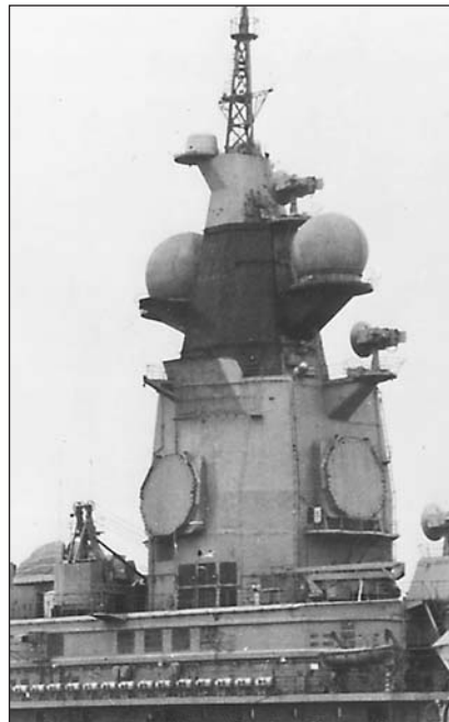
Грот-мачта с антеннами измерительного комплекса
