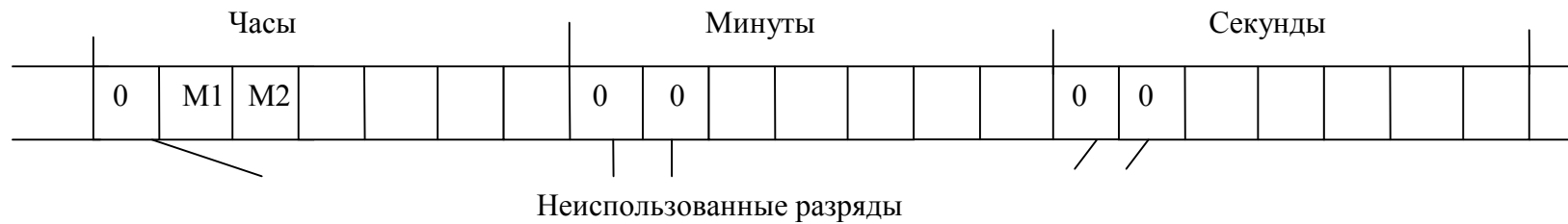
Рисунок 5 – Структура сигналов времени в режиме «КИМ-А»
